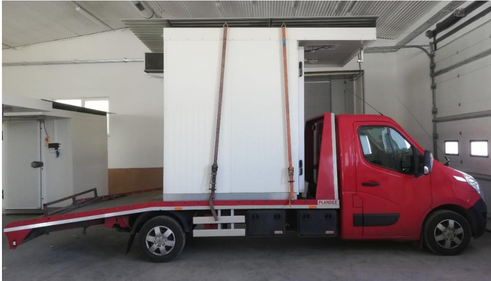
Rys. 11 Chłodnia prawidłowo zabezpieczona na czas transportu
